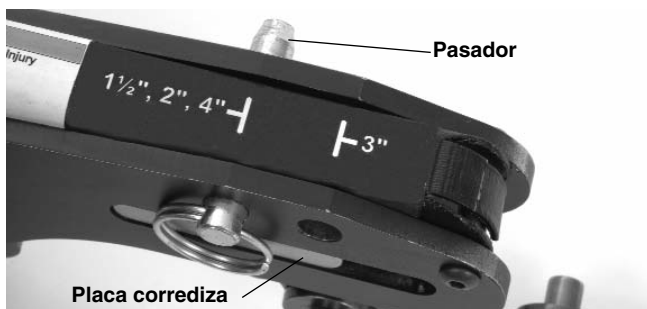
Figura 2 – Regulación del diámetro
