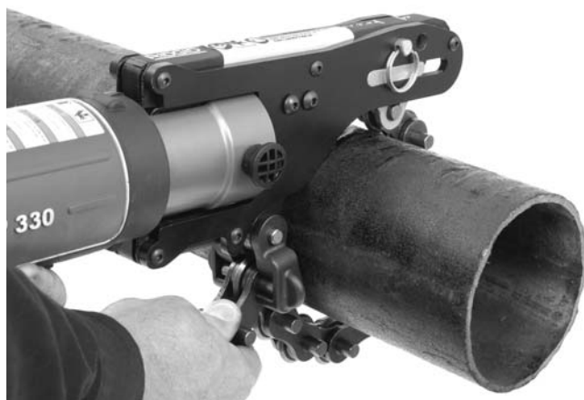
Figura 4 – Ciña la cadena alrededor del tubo
